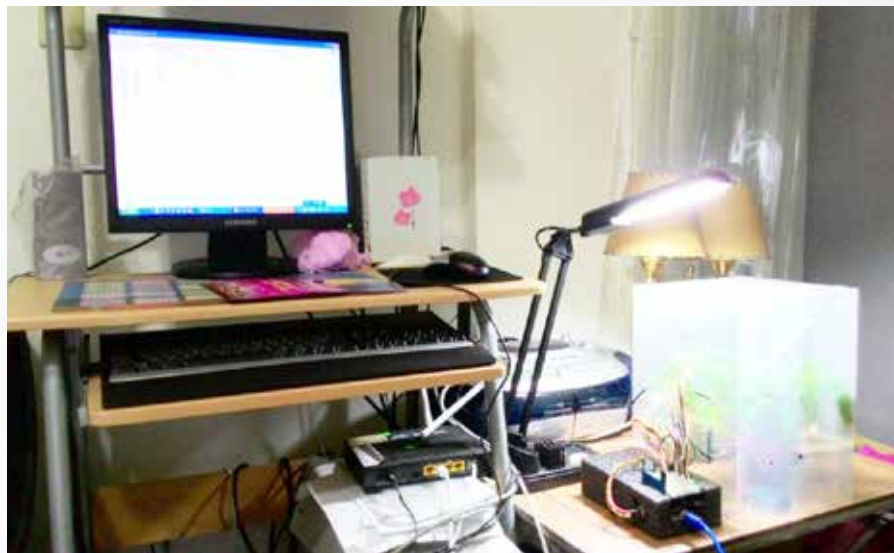
■ 學生組裝的觀測儀器組合之二；利用溫度、濕度、氣壓、光度、二氧化碳、懸浮微粒和揮發性有機氣體等感應器，探討不同植物對空氣品質影響。（陳威志同學提供）
